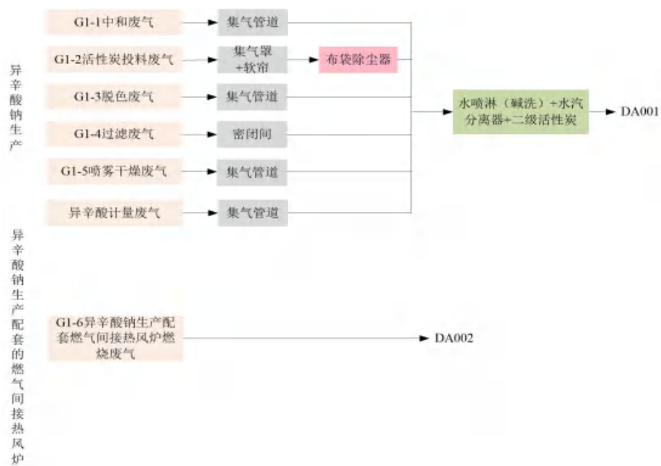
图 3.2-16 异辛酸钠生产废气收集及处理路线示意图
