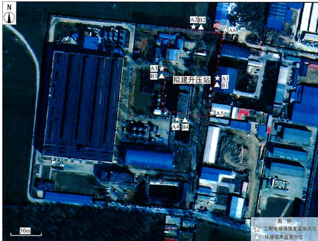
图 4-1 升压站电磁监测点位
