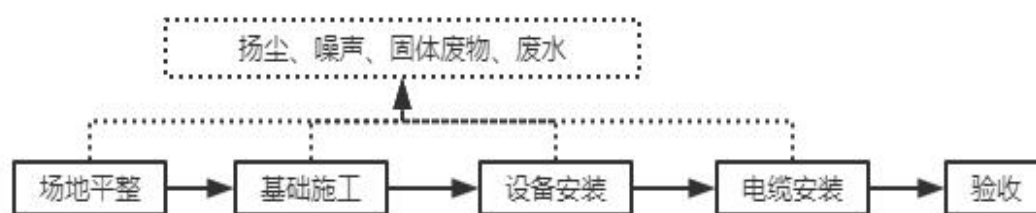
图 2-3 风电场地施工工艺及产污环节图
