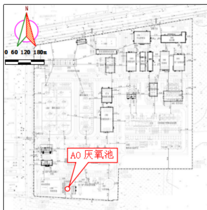
图 5-3-16 地下水污染预测泄露点设定位置图
